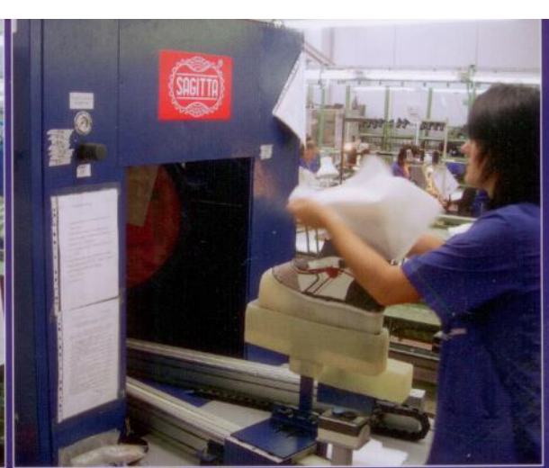
Das Membranset wird auf der Innenseite des Außenschafes positioniert und anschließend in der Diaphragmapresse faltenfrei laminiert.
